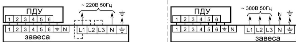
Рис. 3. Схемы подключения завес к электросети и пульту управления
