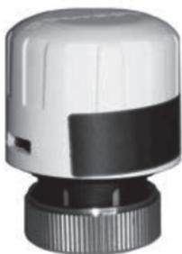
Термоэлектропривод VAG 230 используется для управления клапанами для фанкойлов VVG. При отсутствии электропитания клапан находится в закрытом положении.
